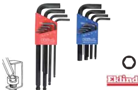
Llave acodada Allen. 9 piezas. Cromo-vanadio pavonado. DIN 911.
