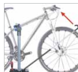
Varilla metálica ajustable para fijación del manillar
