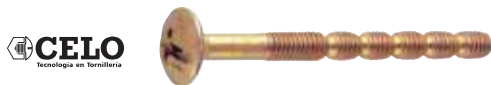
Tornillo tirador cortable. Bicromatado. Cabeza alomada. Ranura combinada plana/Pozidriv. El diseño del vástago permite seleccionar el largo necesario.
